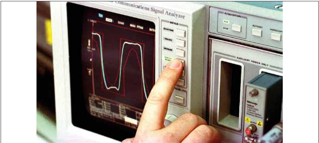
**Figura 2.** Teste de desempenho a partir dos bits de um sinal digital
