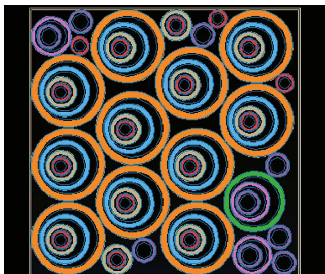
Figura 12. Rendimento das placas de PTFE com o corte das juntas de vedação
