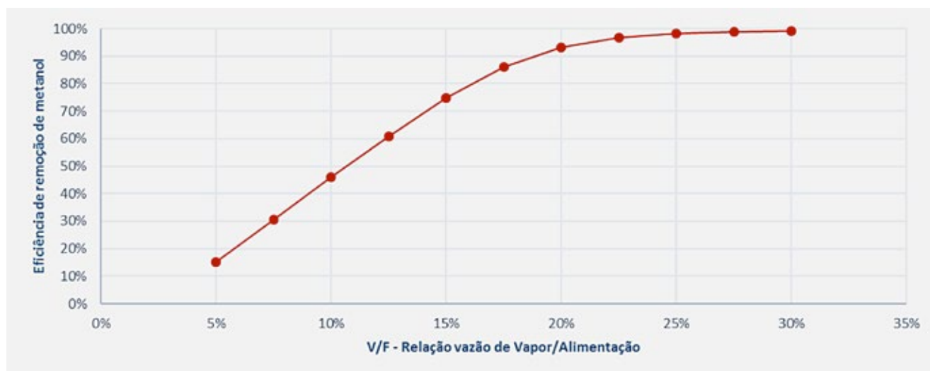
Gráfico 1 – Eficiência de remoção de metanol do condensado contaminado variando a vazão de vapor de alimentação de uma coluna de esgotamento/stripping
